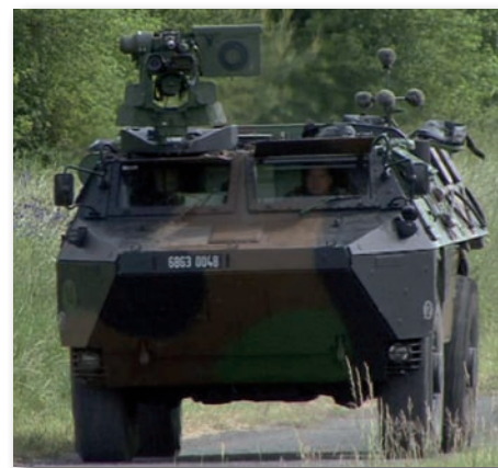
VAB TOP (Renault Truck) équipé d'un système Pilar / VAB TOP (Renault Truck) equipped with a Pilar system.
